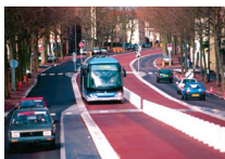
דוגמא לתח"צ שמאלי - האופציה המוצעת במקטעי העדפת תחבורה ציבורית לאורך רחוב הרצל
